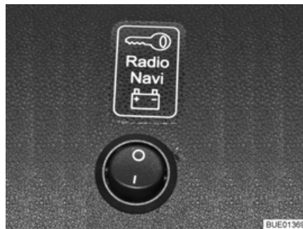
Bild 117 Wahlschalter für Betriebsverhalten
