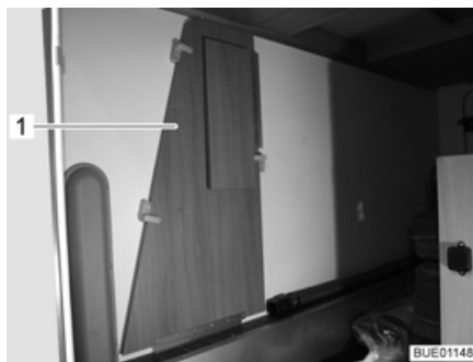
Bild 11 Bettverbreiterung in Heckgarage
