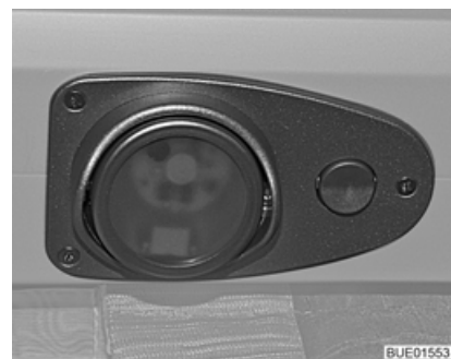
Bild 191 LED-Leuchte mit Schalter
