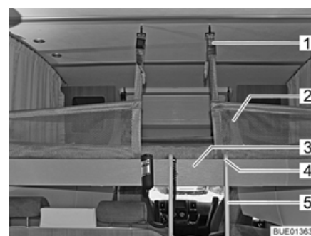
Billede 122 Hejseseng med opspændt sikkerhedsnet
