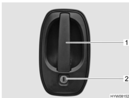
Billede 61 Dørlås (førerdør/indgangsdør udvendigt)
