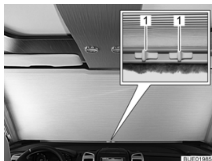
Billede 19 Manuel sikring af gardin i forruden
