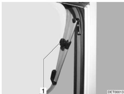
Billede 95 Ventilationsrude med drejedyder
