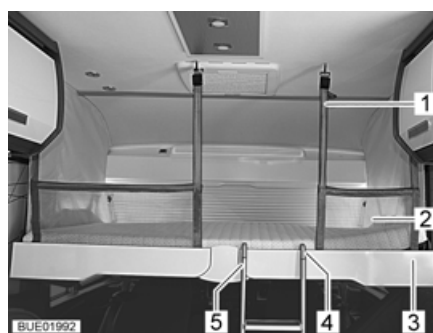
Billede 120 Hejseseng med opspændt sikkerhedsnet
