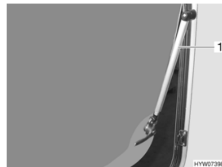
Billede 96 Ventilationsrude med automatiske udskydere
