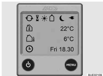
Fig. 135 Schermata iniziale (centralina di controllo)
