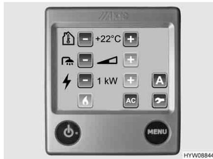
Fig. 136 Menu delle impostazioni (centralina di controllo)
