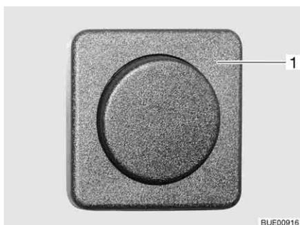
Fig. 59 Interruttore, separato dalla lampada (esempio)
