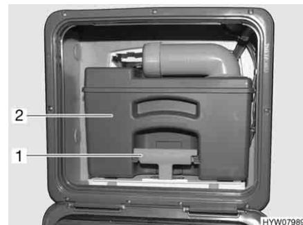
Fig. 180 Serbatoio fecale
