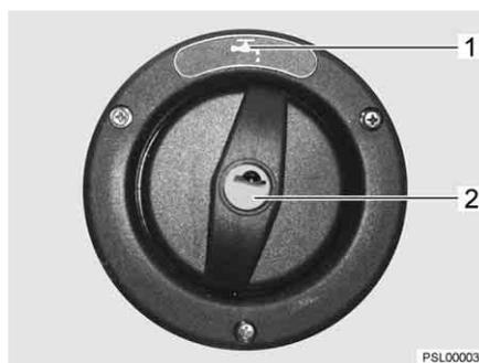
Fig. 43 Coperchio per bocchettone di riempimento dell'acqua potabile
