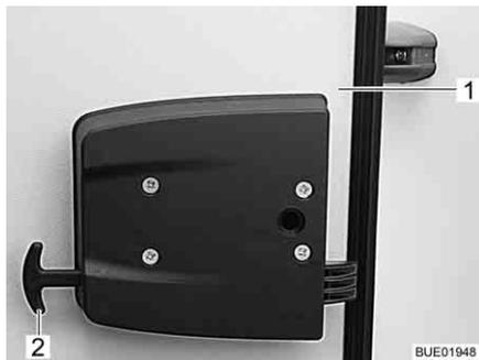
Fig. 39 Sbloccaggio di emergenza dello sportello del garage
