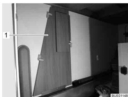
Fig. 11 Allargamento letto nel garage di coda
