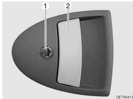
Fig. 33 Serratura della porta di ingresso, lato esterno
