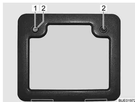
Fig. 41 Serratura a pressione sportello di servizio (alternativa)
