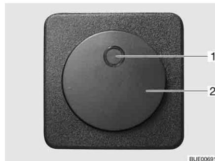
Fig. 145 Interruttore per riscaldamento elettrico del pavimento
