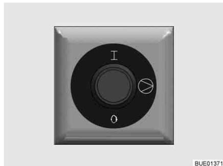
Fig. 141 Interruttore di comando pompa di circolazione aggiuntiva
