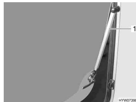
Fig. 69 Finestra apribile con deflettore automatico
