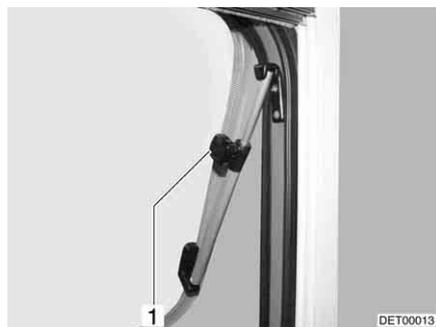
Fig. 68 Finestra apribile con deflettore a rotazione
