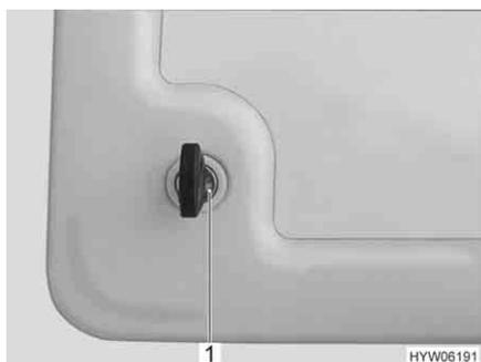
Fig. 40 Serratura a pressione sportello di servizio
