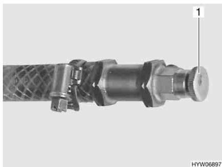
Fig. 184 Valvola di sfiato del riscaldamento ad acqua calda
