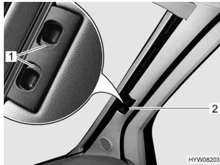
Fig. 22 Tendina oscurante pieghevole per il parabrezza
