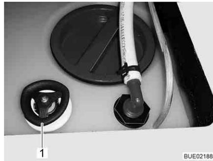
Fig. 166 Serbatoio dell'acqua con maniglia girevole
