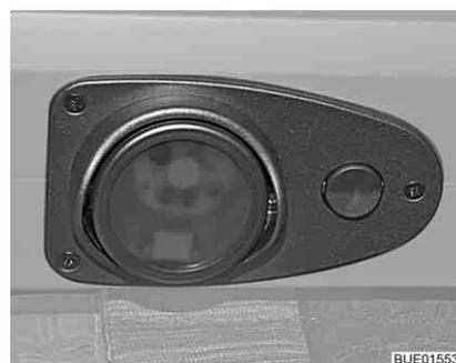
Bild 190 LED-Leuchte mit Schalter
