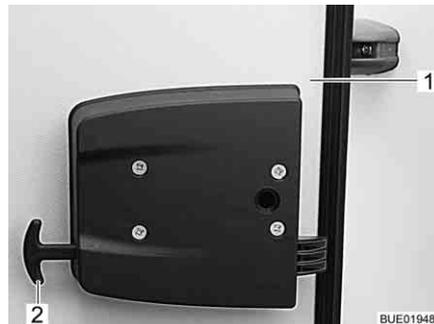
Bild 39 Notentriegelung Garagenklappe
