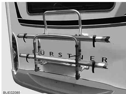
Bild 1 Fahrradträger, nicht absenkbar
