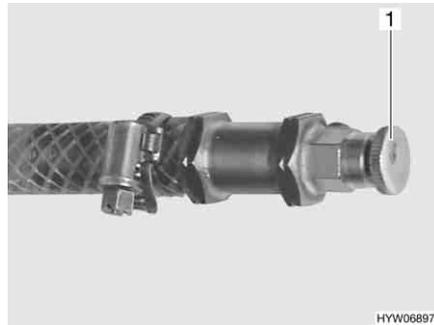
Bild 184 Entlüftungsventil Warmwasser-Heizung
