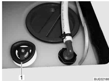
Bild 167 Wassertank mit Drehgriff
