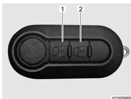
Bild 31 Fernbedienung Zentralverriegelung (2 Tasten)
