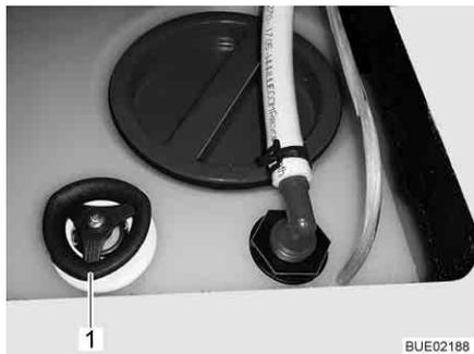
Bild 182 Wassertank mit Drehgriff
