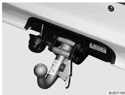
Bild 6 Anhängerkupplung, abnehmbar
