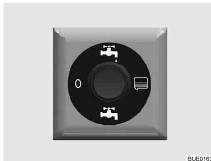
Bild 170 Bedienschalter für elektrisch betätigtes Ablassventil
