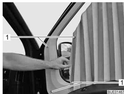
Bild 75 Befestigung Faltschirm
