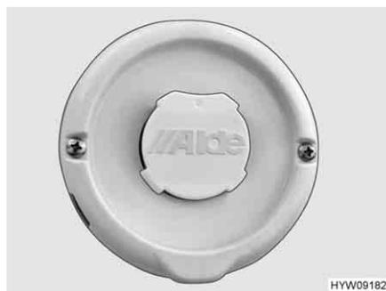
Bild 143 Wandkamin (Warmwasser-Heizung)
