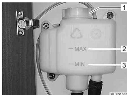
Bild 183 Ausgleichsbehälter ohne Blende
