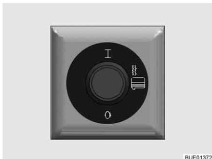
Bild 171 Schalter für Abwasserheizung
