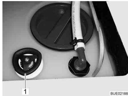
Bild 166 Wassertank mit Drehgriff
