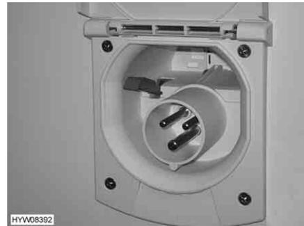
Bild 121 230-V-Anschluss am Fahrzeug
