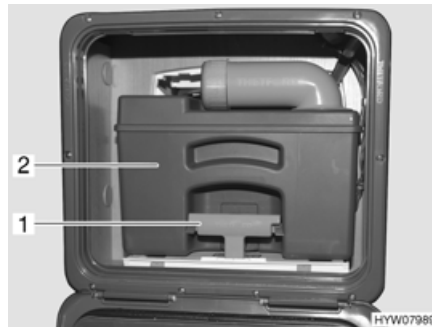
Fig. 209 Serbatoio fecale (esempio)
