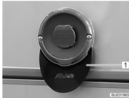
Fig. 165 Convogliatore di condensa del camino
