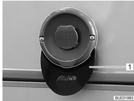
Fig. 13 Convogliatore di condensa del camino
