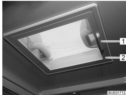
Bild 111 Taklucka med snäplås
