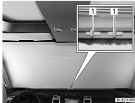
Bild 19 Manuell mörkläggningsgardinen för vindrutan
