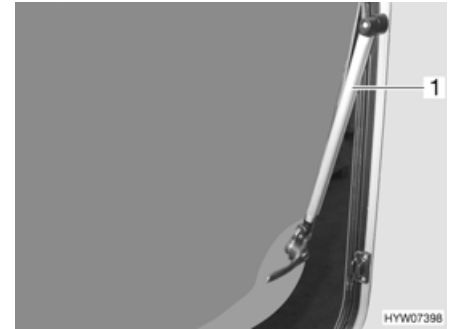
Bild 96 Överkantshängt fönster med automatik-spärr
