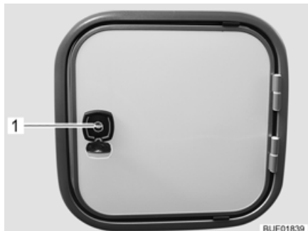
Bild 208 Lucka för latrintank
