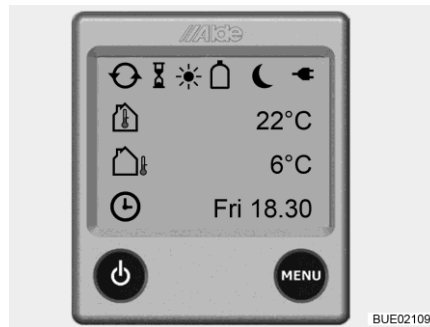
Fig. 210 Schermata iniziale (centralina di controllo)
