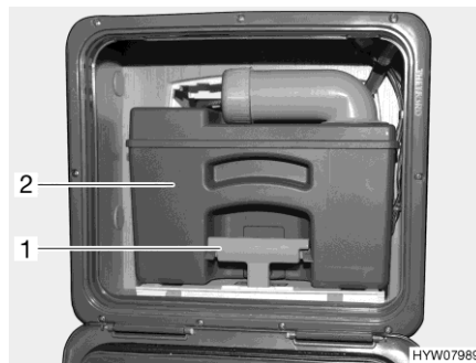
Fig. 275 Serbatoio fecale (esempio)
