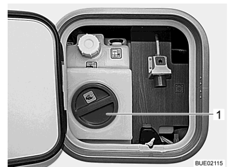
Fig. 278 Ouverture de nettoyage du réservoir d'eau (unité de service)
