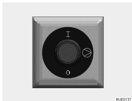
Fig. 216 Commutateur de commande du circulateur supplémentaire
