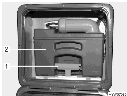
Fig. 266 Réservoir pour matières fécales (exemple)
