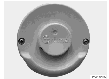
Fig. 219 Cheminée murale (chauffage à air chaud)
