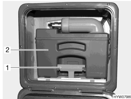
Fig. 275 Depósito de aguas fecales (ejemplo)
