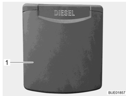
Fig. 56 Trampilla exterior, tubo de llenado de combustible
