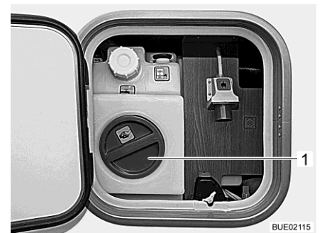
Fig. 278 Orificio de limpieza del depósito de agua (unidad de servicio)
