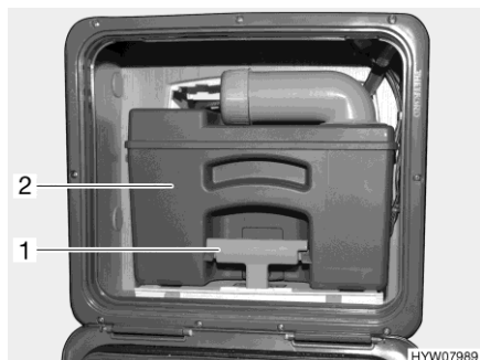
Fig. 266 Depósito de aguas fecales (ejemplo)
