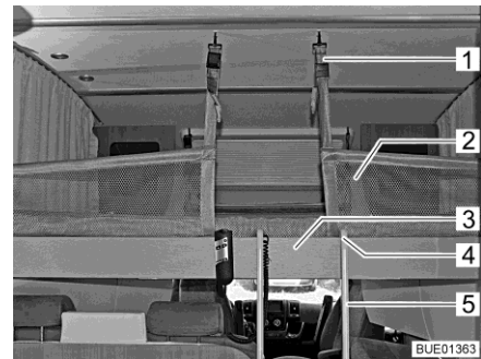
Fig. 142 Cama elevada con red de seguridad tendida
