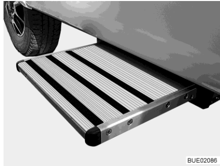
Fig. 10 Escalón de entrada
