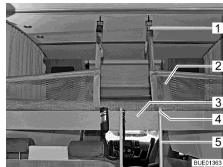
Afb. 142 Hefbed met gespannen veiligheidsnet
