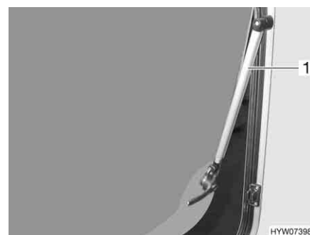
Billede 69 Ventilationsrude med automatiske udskydere
