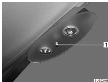
Billede 55 Spotlampe, lyskontakt direkte ved lampen
