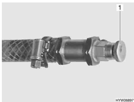
Billede 184 Udluftningsventil varmtvandsvarmeovn
