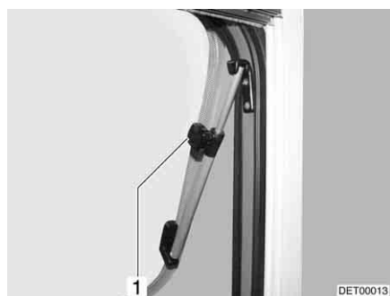
Billede 68 Ventilationsrude med drejeudskyder
