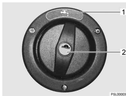
Fig. 43 Tapa de cierre para el tubo de llenado de agua potable
