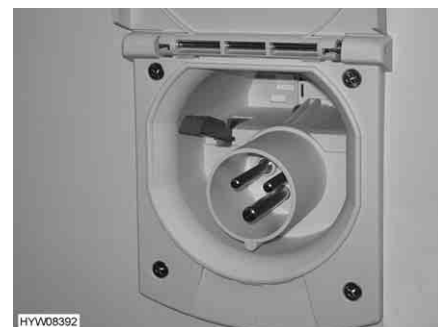
Fig. 121 Conexión de 230 V en el vehículo
