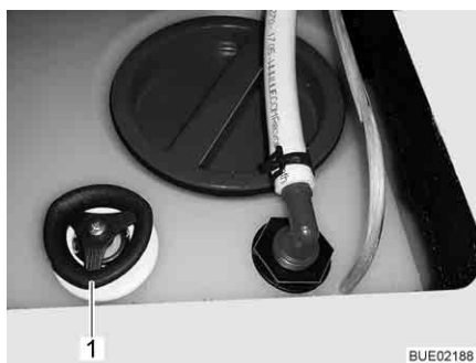
Fig. 166 Depósito de agua con tirador giratorio
