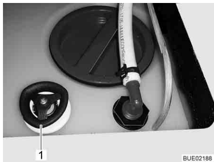
Fig. 182 Depósito de agua con tirador giratorio
