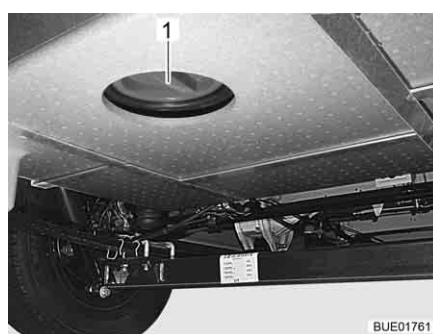
Fig. 181 Orificio de limpieza del depósito de aguas residuales
