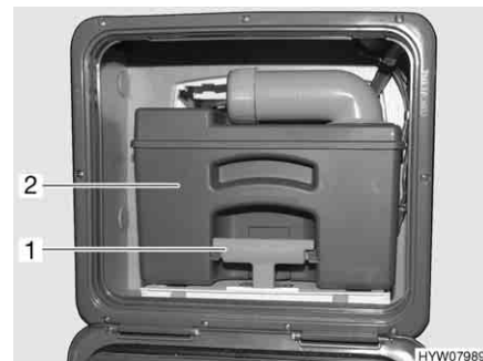
Fig. 180 Depósito de aguas fecales
