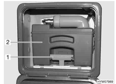
Fig. 174 Depósito de aguas fecales (ejemplo)
