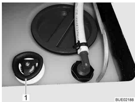
Fig. 167 Depósito de agua con tirador giratorio
