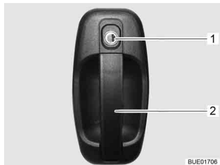
Billede 67 Indgangsdørens dørlås, udvendigt
