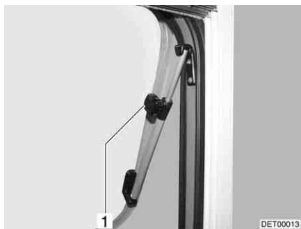
Billede 109 Ventilationsrude med drejeudskydere
