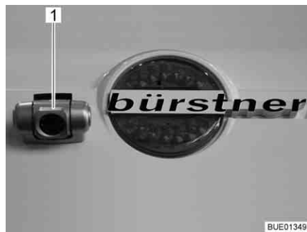
Billede 22 Bakkamera med infrarødt lys
