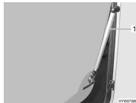
Billede 110 Ventilationsrude med automatiske udskydere
