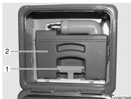
Billede 247 Toilet-tank (eksempel)
