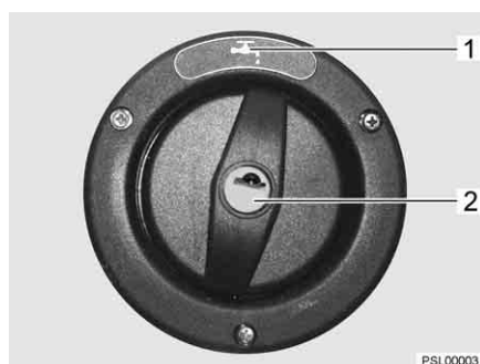
Fig. 218 Couvercle de fermeture pour bec de remplissage d'eau potable
