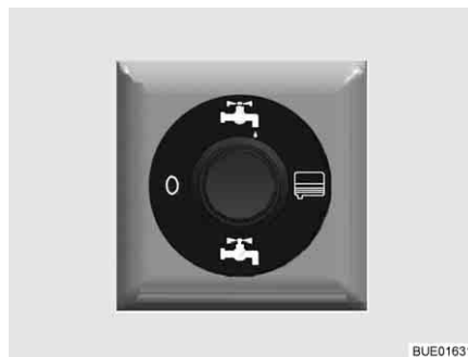
Fig. 231 Commutateur de commande du robinet de vidange à commande électrique (partiellement équipement spécial)
