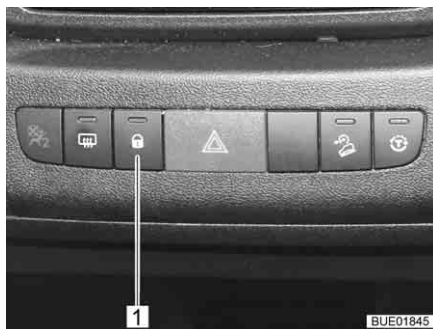
Fig. 59 Interrupteur du verrouillage centralisé (Elegance)
