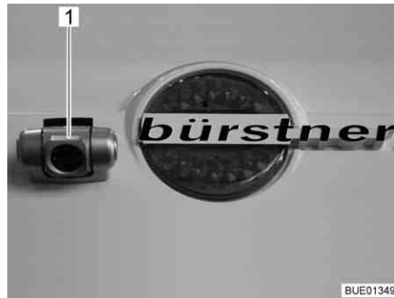
Fig. 19 Caméra de marche arrière avec éclairage à infrarouge
