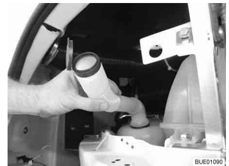
Fig. 44 Bec de remplissage en position de remplissage
