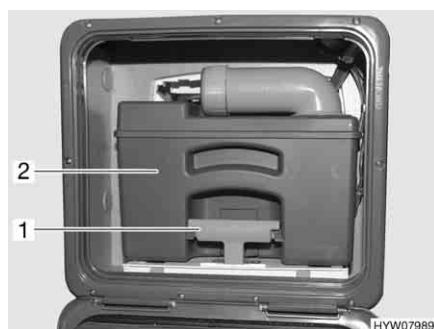
Fig. 246 Réservoir pour matières fécales (exemple)
