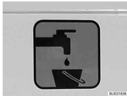
Fig. 229 Symbole du tuyau de purge
