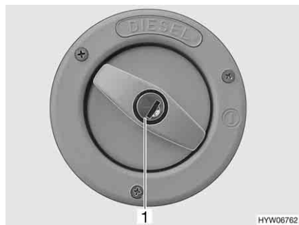
Fig. 45 Tapa de cierre para el tubo de llenado de combustible
