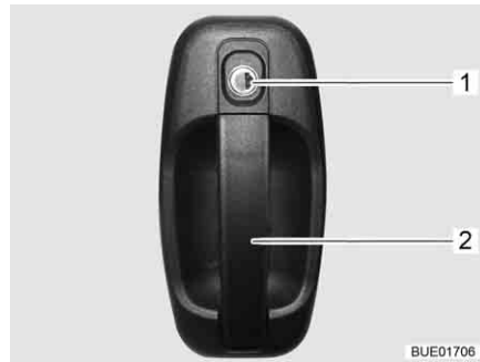
Fig. 63 Cerradura de la puerta de entrada, en el exterior
