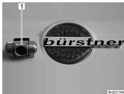
Fig. 19 Cámara de marcha atrás con iluminación infrarroja
