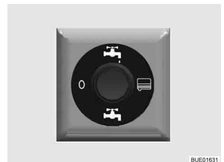
Fig. 231 Conmutador de mando para la llave de desagüe de accionamiento eléctrico (en parte equipamiento especial)
