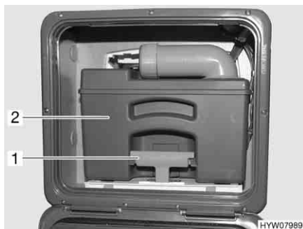
Fig. 246 Depósito de aguas fecales (ejemplo)
