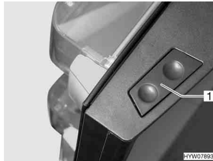
Fig. 211 Botón de desbloqueo de la puerta del frigorífico (Dometic de la serie 8)
