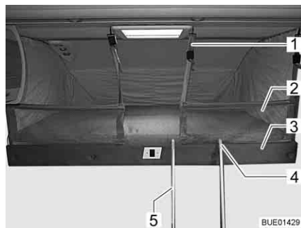
Fig. 136 Cama elevada con red de seguridad tendida
