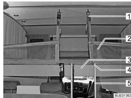
Fig. 139 Cama elevada con red de seguridad tendida
