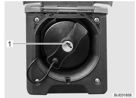
Fig. 47 Tapa de cierre para el tubo de llenado de combustible
