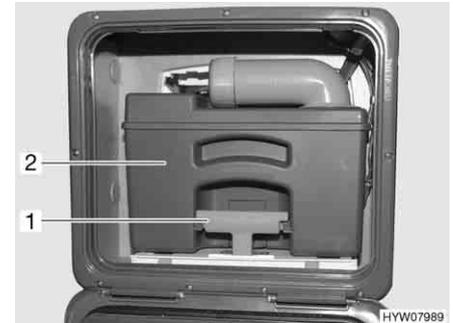
Fig. 219 Serbatoio fecale (esempio)
