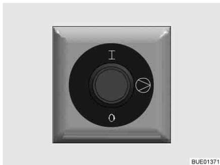
Fig. 175 Interruttore di comando pompa di circolazione aggiuntiva
