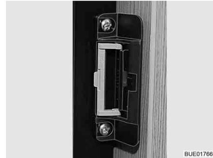
Fig. 205 Dispositivo di chiusura in posizione di ricircolo d'aria
