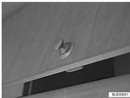
Fig. 47 Sportello del mobile con bottone automatico
