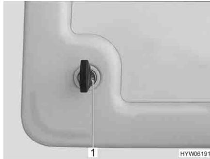
Fig. 46 Serratura a pressione sportello di servizio
