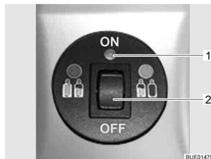
Fig. 135 Centralina di controllo con visualizzatore a distanza
