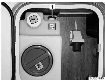
Fig. 209 Serbatoio dell'acqua (unità di alimentazione centrale)
