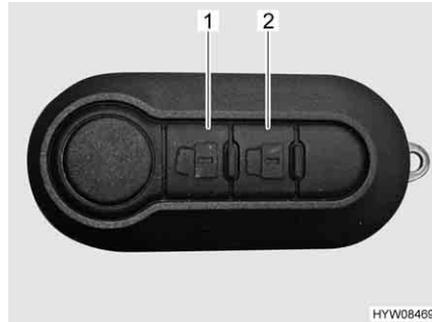
Fig. 37 Telecomando chiusura centralizzata
