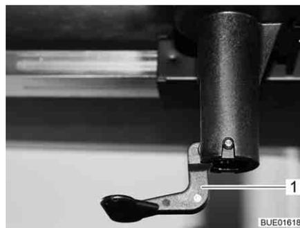
Fig. 93 Sbloccaggio del piano del tavolo
