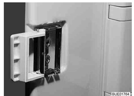
Fig. 203 Dispositivo di chiusura in posizione di ricircolo d'aria
