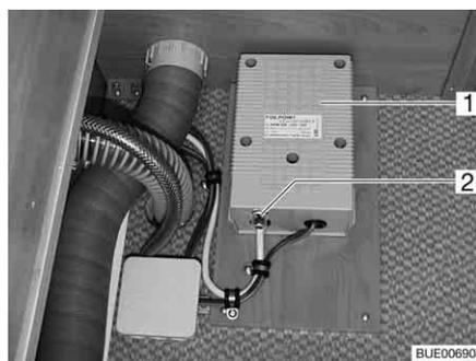
Fig. 178 Trasformatore per riscaldamento elettrico del pavimento
