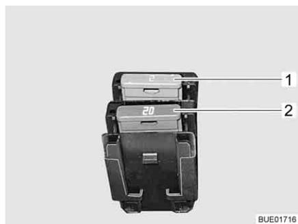
Fig. 151 Fusibili per letto basculante
