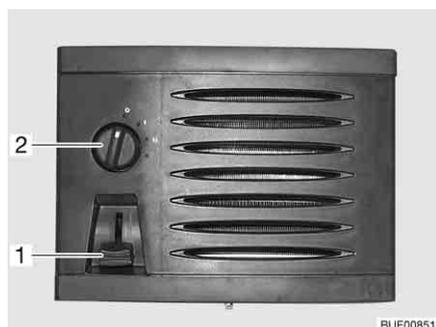
Fig. 177 Elementi di comando dello scambiatore di calore aggiuntivo
