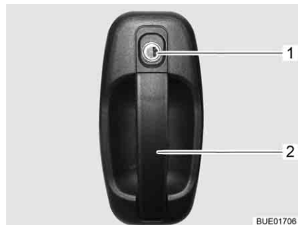
Kuva 40 Sisäänkäyntioven lukko, ulkoa
