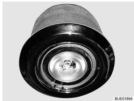
Kuva 55 Kattovalaisin, erillään kytkimestä (esimerkki)
