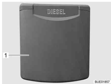
Kuva 46 Polttoaineen täyttöaukon ulkoluukku
