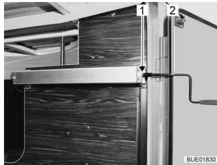
Kuva 143 Takatallissa sijaitseva kampi
