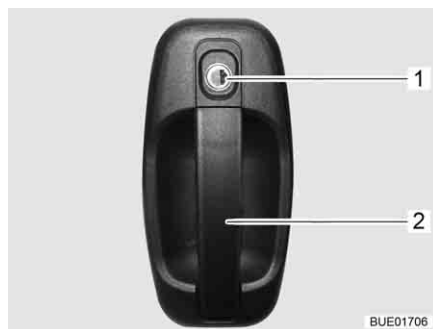
Kuva 63 Sisäänkäyntioven lukko, ulkoa
