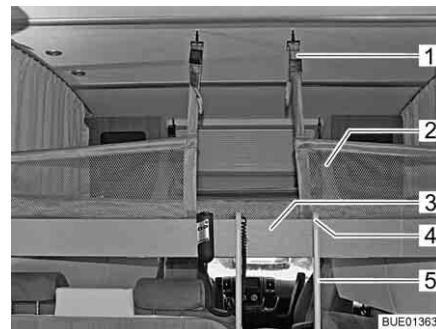
Bild 139 Hubbett mit aufgespanntem Sicherungsnetz
