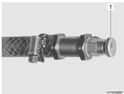
Billede 253 Udluftningsventil varmtvandsvarmeovn
