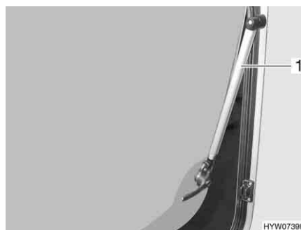
Billede 104 Ventilationsrude med automatiske udskydere
