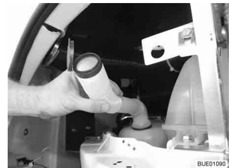
Fig. 44 Bocchettone di riempimento in posizione di riempimento
