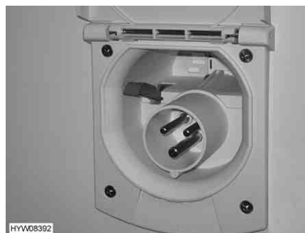
Fig. 162 Collegamento a 230 V sul veicolo
