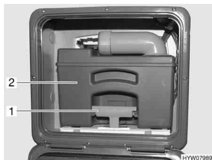
Fig. 246 Serbatoio fecale (esempio)
