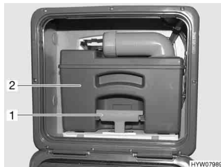
Fig. 237 Serbatoio fecale (esempio)
