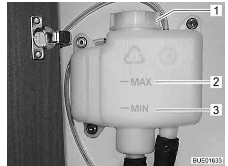
Fig. 252 Vaso d'espansione senza diaframma
