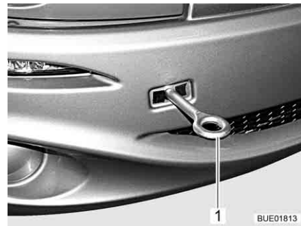
Fig. 49 Occhione di traino, installato
