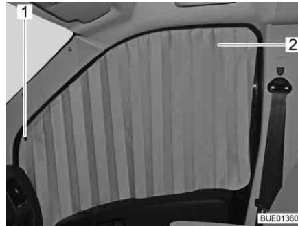
Bild 62 Plisséförhänge vid passagerarfönster
