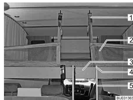
Bild 116 Hubbett mit aufgespanntem Sicherungsnetz
