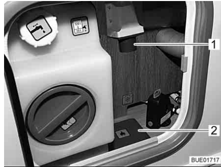
Bild 157 230-V-Anschluss am Fahrzeug (mit zentraler Versorgungseinheit)
