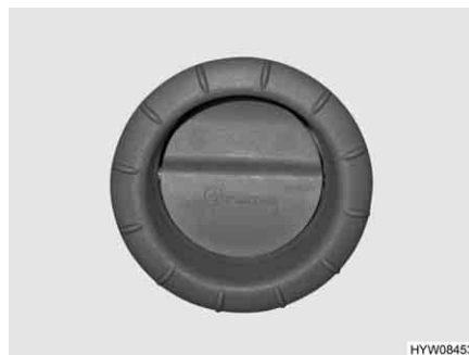
Bild 177 Luftaustrittsdüse der Warmluftheizung
