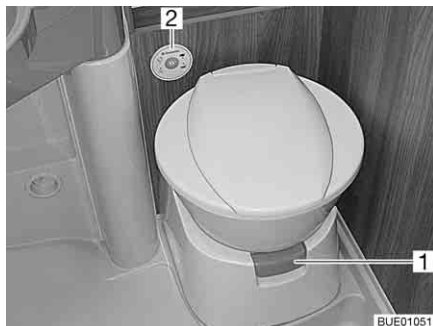
Bild 252 Toilettenschüssel mit Kontroll- und Bedieneinheit
