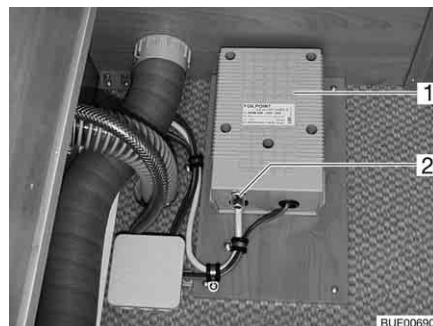
Bild 193 Trafo für elektrische Fußbodenerwärmung
