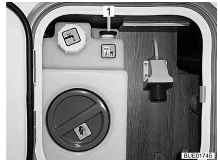
Bild 232 Wassertank (zentrale Versorgungseinheit)
