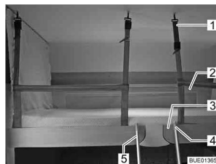
Bild 114 Hubbett mit aufgespanntem Sicherungsnetz
