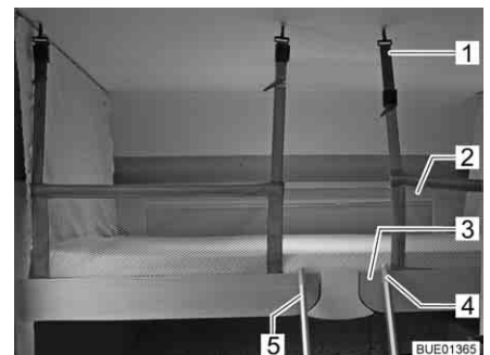
Afb. 114 Hefbed met gespannen veiligheidsnet
