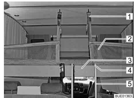
Afb. 116 Hefbed met gespannen veiligheidsnet
