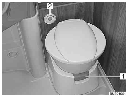
Kuva 252 WC-istuin ja valvonta- ja säätöyksikkö
