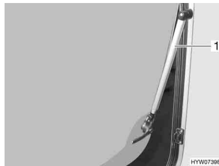
Kuva 75 Avattavat ikkunat, joissa on automaattipidikkeet
