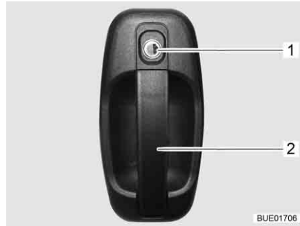
Kuva 41 Sisäänkäyntioven lukko, ulkoa
