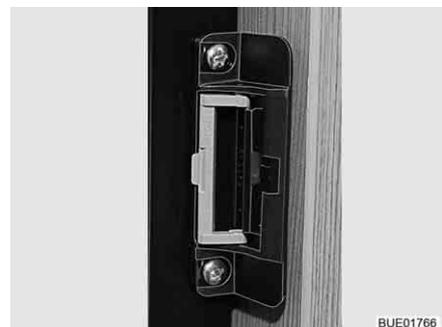
Fig. 226 Dispositivo de cierre en posición de ventilación
