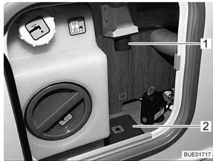
Fig. 157 Conexión de 230 V en el vehículo (con unidad de alimentación centralizada)
