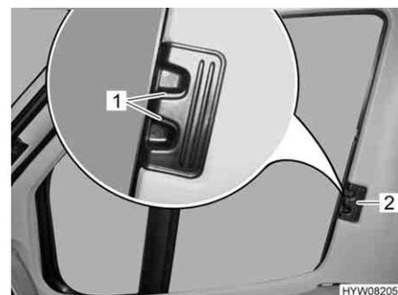
Fig. 30 Estor plegable para la ventana del conductor/acompañante
