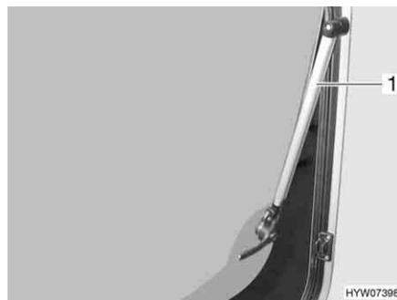
Fig. 75 Ventana abatible con soporte automático
