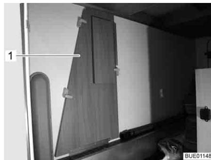
Fig. 16 Ensanchamiento de cama en el garaje trasero
