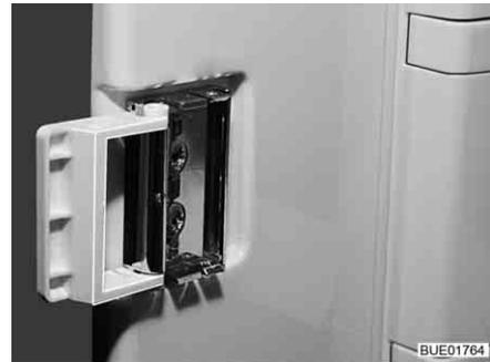
Fig. 224 Dispositivo de cierre en posición de ventilación
