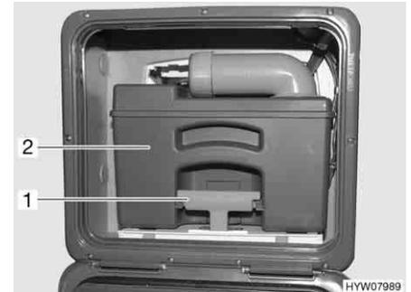
Fig. 255 Depósito de aguas fecales
