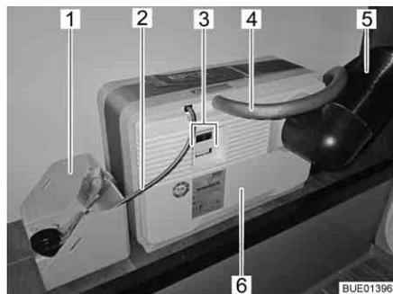
Fig. 151 Pila de combustión con cartucho de metanol
