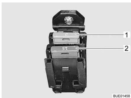
Fig. 165 Fusibles para pila de combustión
