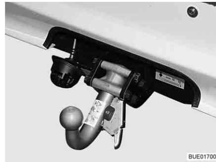
Fig. 10 Acoplamiento de remolque, desmontable
