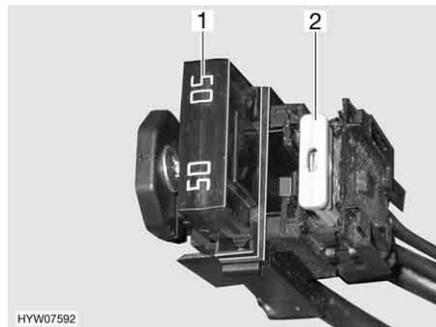
Fig. 161 Fusibles en la batería del habitáculo
