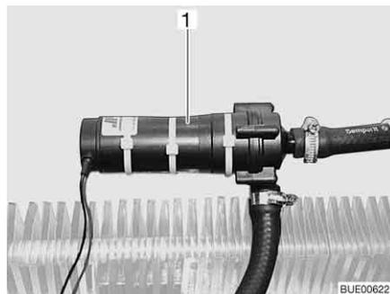
Fig. 190 Bomba de circulación adicional
