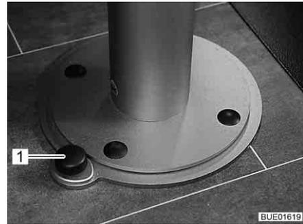
Fig. 101 Desbloqueo de la pata de mesa
