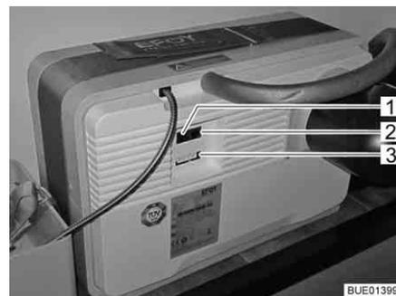
Fig. 152 Campo de conexiones de la pila de combustión
