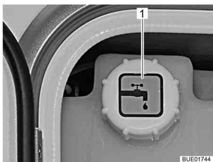
Fig. 227 Tapa de cierre para tubo de llenado de agua potable (unidad de alimentación centralizada)
