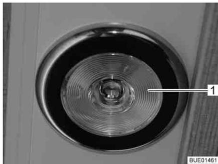
Fig. 60 Lámpara empotrada, interruptor de luz dentro de la lámpara
