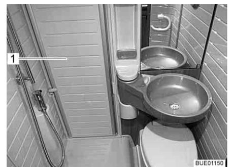
Fig. 19 Panel de separación de la ducha
