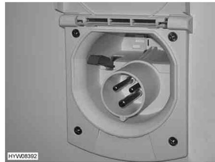
Fig. 158 Conexión de 230 V en el vehículo (sin unidad de alimentación centralizada)
