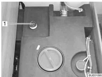
Fig. 233 Depósito de agua con tirador giratorio (Ixeo)
