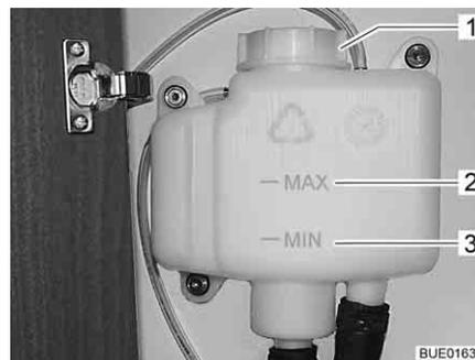
Fig. 259 Recipiente de compensación sin panel
