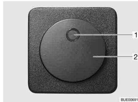
Fig. 194 Interruptor para calentamiento eléctrico del piso
