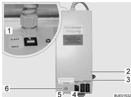
Fig. 241 Transformador con aparato regulador
