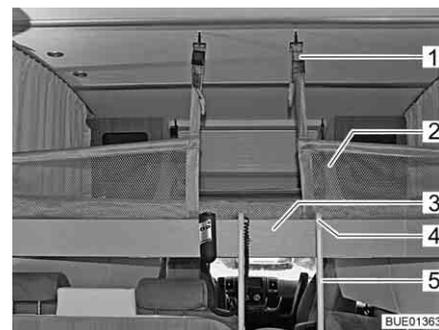
Fig. 116 Cama elevada con red de seguridad tendida
