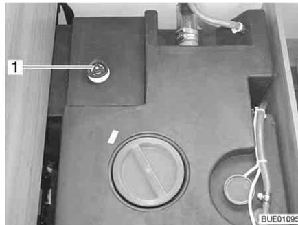
Fig. 231 Depósito de agua con tirador giratorio (Ixeo)
