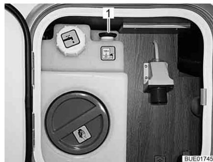
Fig. 234 Depósito de agua (unidad de alimentación centralizada)
