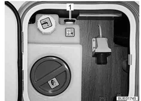
Fig. 232 Depósito de agua (unidad de alimentación centralizada)
