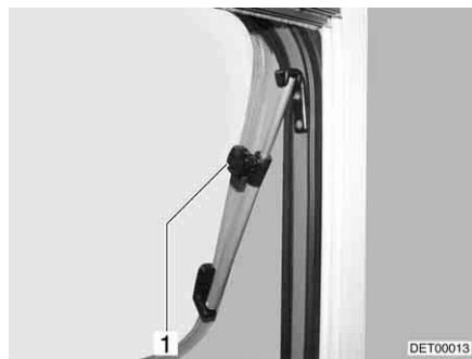
Kuva 53 Avattavat ikkunat, joissa on kääntöpidike
