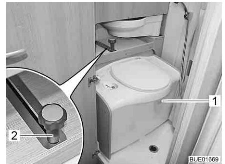
Kuva 173 WC, vedettynä ulos
