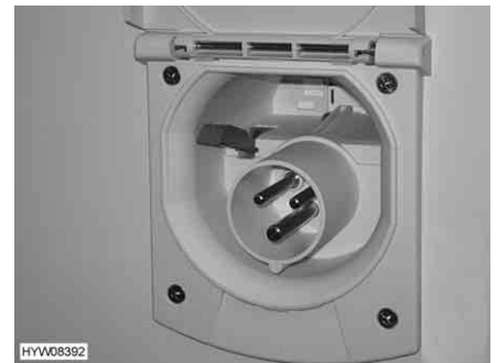
Fig. 109 Collegamento a 230 V sul veicolo
