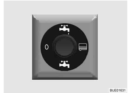
Bild 205 Brytare för elmanövrerad avtappningskran
