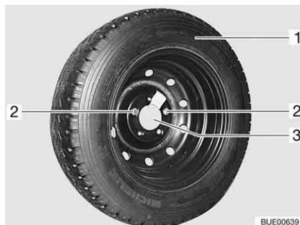
Fig. 250 Soporte para rueda de repuesto en el garaje trasero
