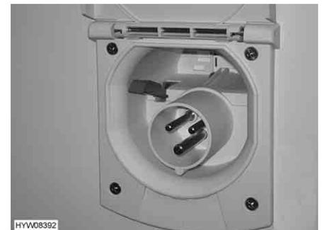
Fig. 143 Conexión de 230 V en el vehículo
