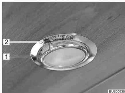
Fig. 237 Lámpara halógena empotrada (plana)
