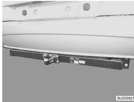
Fig. 10 Acoplamiento de remolque
