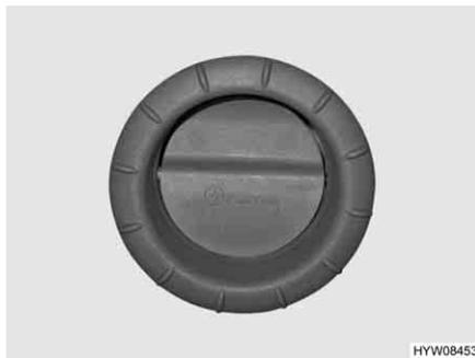
Fig. 163 Boquilla de salida de aire
