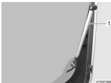
Fig. 81 Ventana abatible con soporte automático
