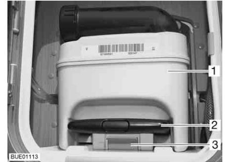
Fig. 215 Depósito de aguas fecales
