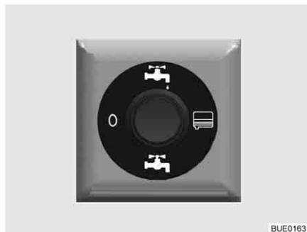
Fig. 205 Conmutador de mando para la llave de desagüe de accionamiento eléctrico
