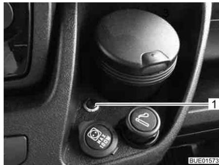
Fig. 37 Pulsador para activar el control remoto
