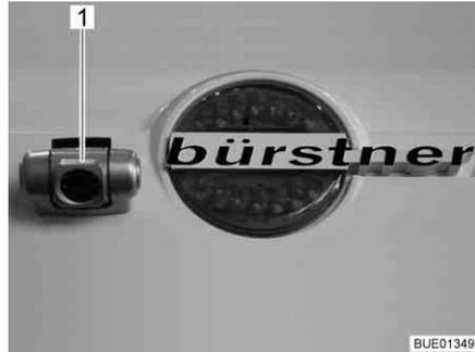
Fig. 20 Cámara de marcha atrás con iluminación infrarroja (Waeco)
