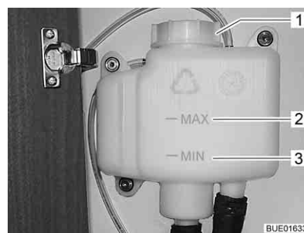
Billede 228 Udligningsbeholder uden blænde
