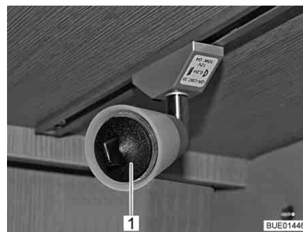
Billede 239 Sugestik til udskiftning af pære
