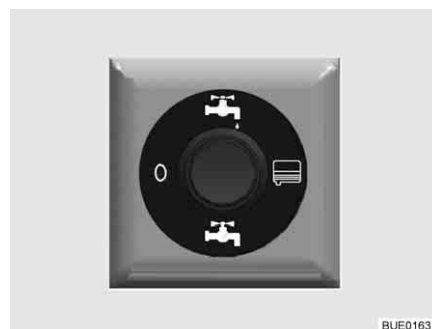
Fig. 205 Interruttore di comando per rubinetto di scarico ad azionamento elettrico
