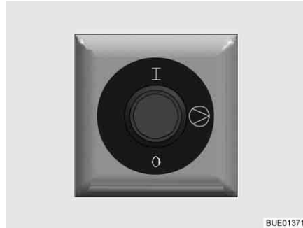
Fig. 172 Interruttore di comando pompa di circolazione aggiuntiva
