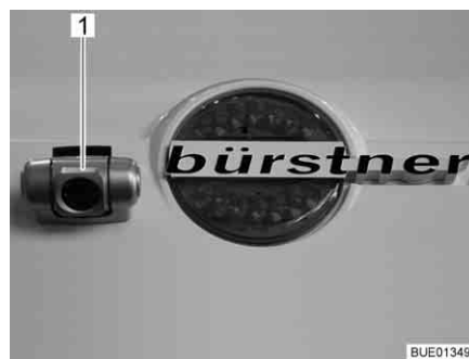
Bild 17 Backningskamera med infraröd belysning (Waeco)
