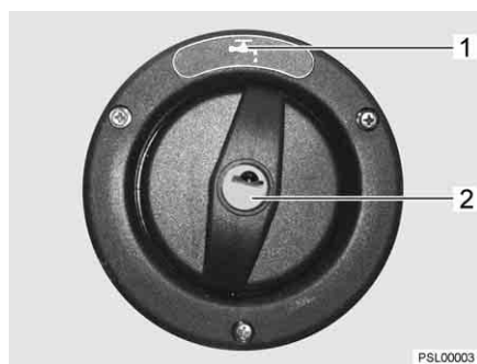
Fig. 237 Tapa de cierre para el tubo de llenado de agua potable
