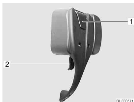
Fig. 45 Cerradura de la puerta de entrada, en el interior, bloqueada
