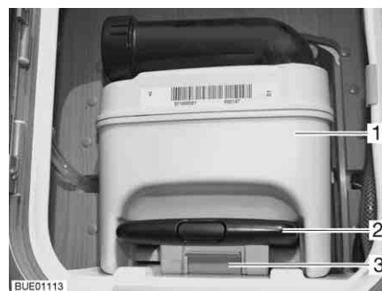
Fig. 249 Depósito de aguas fecales
