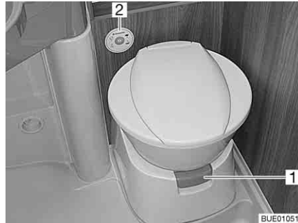
Fig. 258 Taza del inodoro con unidad de control y de mando
