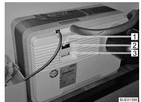
Fig. 169 Campo di collegamento pila a combustibile
