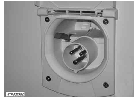
Afb. 174 230-V-aansluiting op het voertuig
