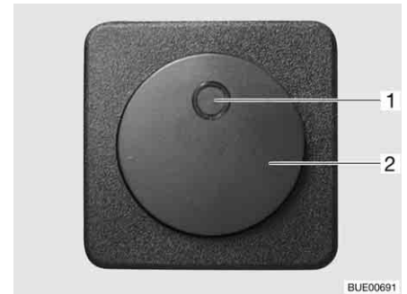
Afb. 206 Schakelaar voor de elektrische vloerverwarming
