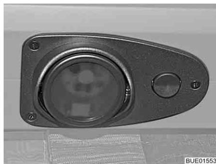
Fig. 243 Lâmpada com LED com interruptor
