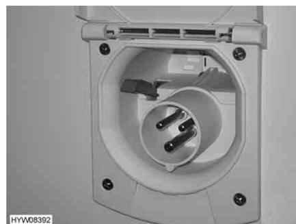
Fig. 140 Ligação de 230 V no veículo
