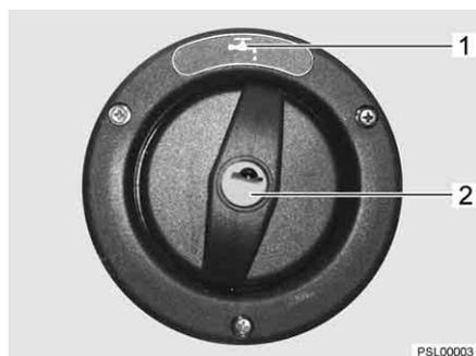
Fig. 195 Tampa de fecho do bocal de enchimento de água potável
