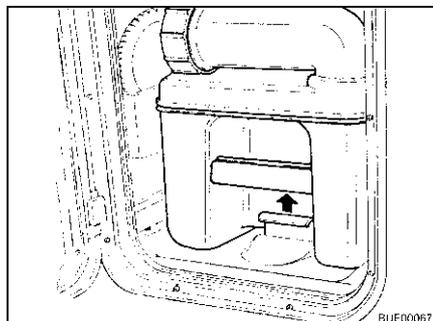
Fig. 221 Puxar o estribo de fixação
