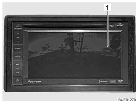
Fig. 23 Ecrã LCD para câmara de recuo (Pioneer)
