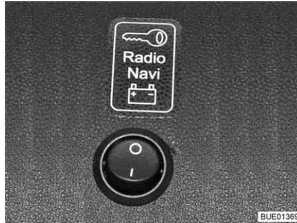
Fig. 129 Interruptor-seletor para o comportamento da bateria
