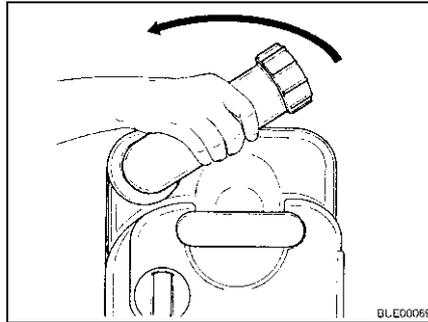
Fig. 207 Girar o bocal de descarga
