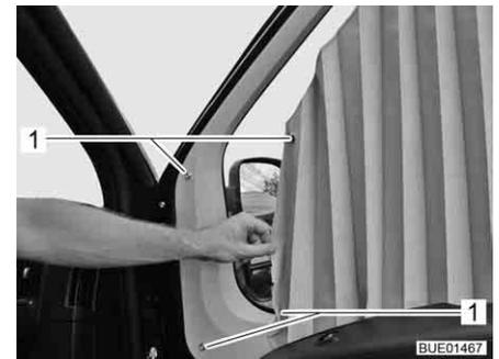
Fig. 86 Fixação da cortina plissada
