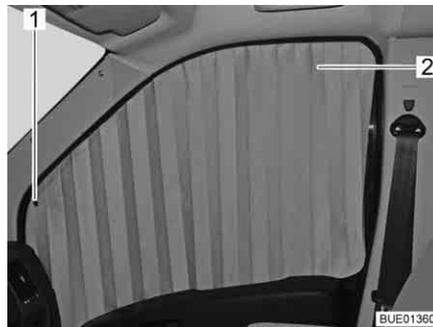
Fig. 85 Cortina plissada na janela do passageiro
