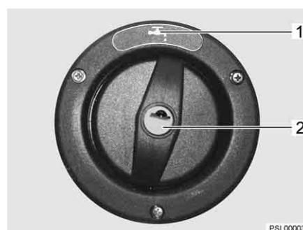
Fig. 52 Tampa de fecho do bocal de enchimento de água potável
