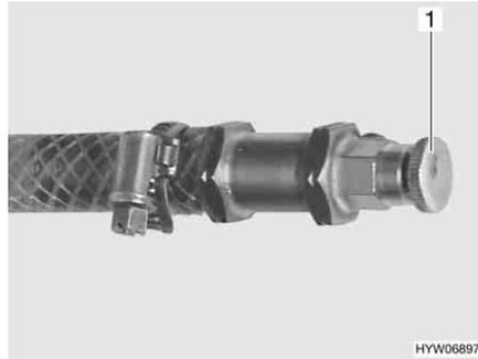
Fig. 236 Válvula de evacuação de ar para o aquecimento de água
