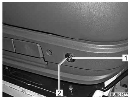
Fig. 25 Interruptor para o aquecimento dos bancos
