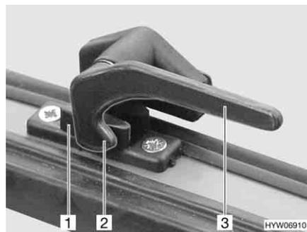
Fig. 96 Alavanca de trava na posição "fechada"
