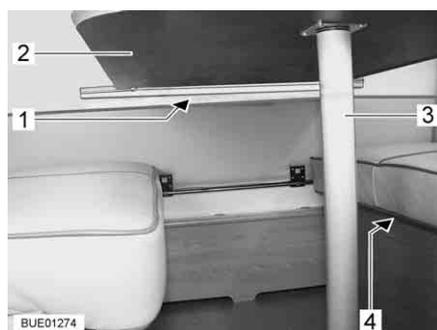
Fig. 104 Mesa suspensa com pé da mesa substituível
