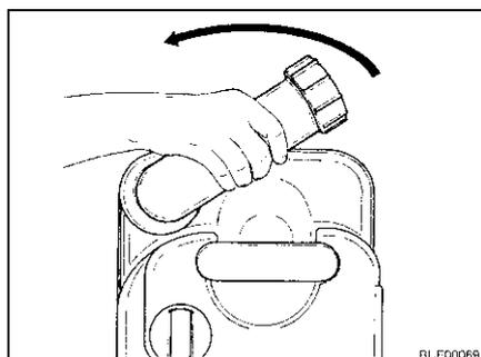
Fig. 223 Girar o bocal de descarga
