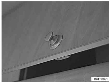
Fig. 53 Alçapão de móvel com botão de pressão
