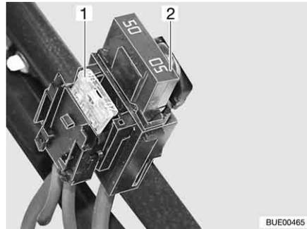
Fig. 142 Fusíveis na bateria de arranque
