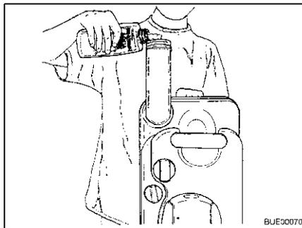
Fig. 208 Abastecer com desinfetante para instalações sanitárias
