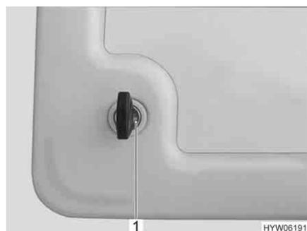
Fig. 50 Fechadura de pressão do alçapão de serviço
