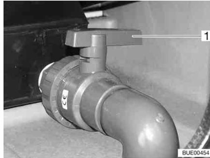
Fig. 198 Torneira de descarga (no chão duplo)
