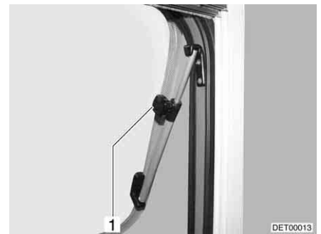
Afb. 97 Dakluik met draaibare uitzetters, geopend
