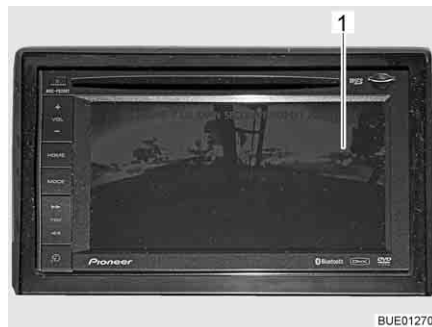
Afb. 23 LCD-monitor voor achteruitrijcamera (Pioneer)
