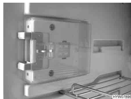
Afb. 194 Sluiting in ventilatiestand
