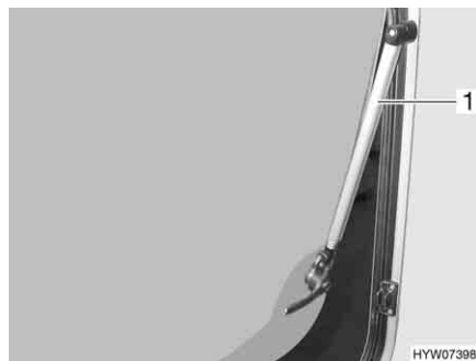
Afb. 80 Uitzetbaar raam met automatische uitzetters
