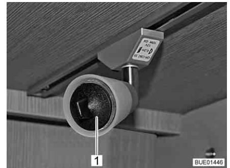
Afb. 246 Zuignap voor het vervangen van lampen
