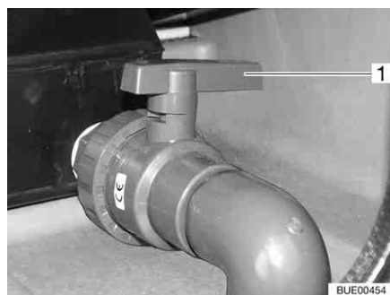
Billede 198 Aftapningshane (i den dobbelte bund)
