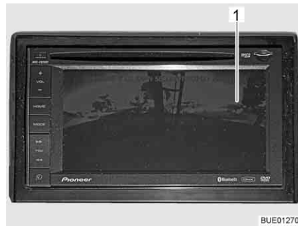
Billede 23 LCD-monitor til bakkamera (Pioneer)
