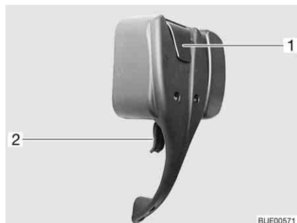
Billede 43 Indgangsdørens lås, indvendigt, låst
