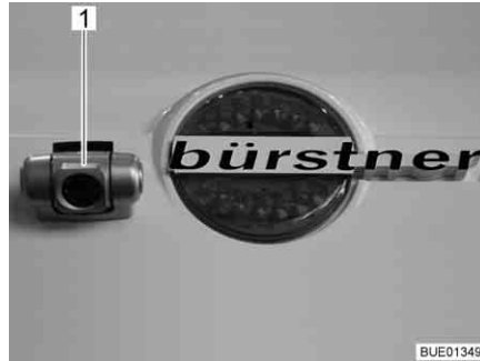
Fig. 16 Cámara de marcha atrás con iluminación infrarroja (Waeco)
