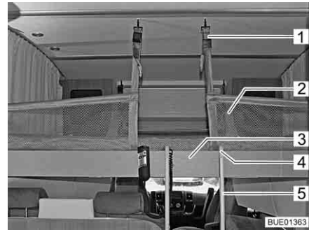
Fig. 125 Cama elevada con red de seguridad tendida
