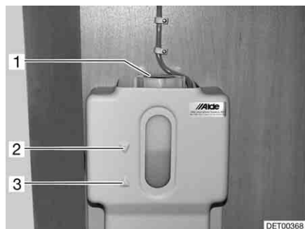
Fig. 281 Recipiente de compensación para la calefacción de agua caliente
