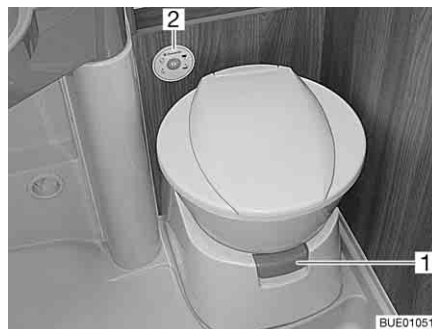
Fig. 277 Taza del inodoro con unidad de control y de mando
