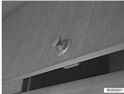
Fig. 67 Trampilla de muebles con botón de presión
