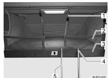
Fig. 122 Cama elevada con red de seguridad tendida
