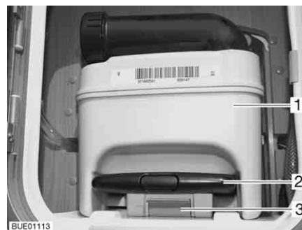
Fig. 274 Depósito de aguas fecales
