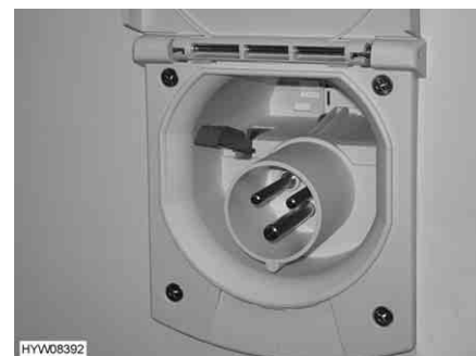
Fig. 166 Conexión de 230 V en el vehículo
