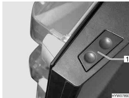
Fig. 225 Botón de desbloqueo de la puerta del frigorífico (Dometic de la serie 8)
