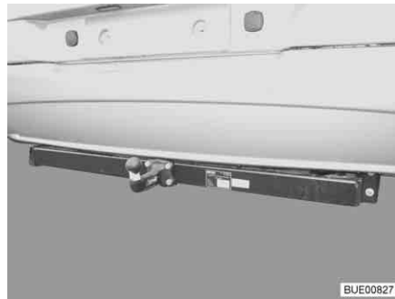
Fig. 9 Acoplamiento de remolque
