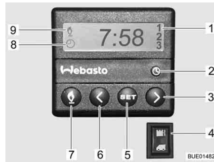
Fig. 110 Unité de commande pour le chauffage d'appoint
