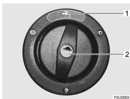
Fig. 128 Tapa de cierre para el tubo de llenado de agua potable
