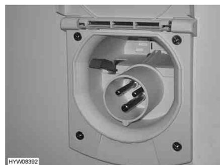
Fig. 90 Conexión de 230 V en el vehículo
