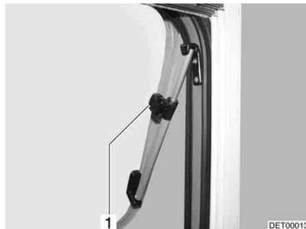
Fig. 48 Ventana abatible con soportes giratorios, abierta
