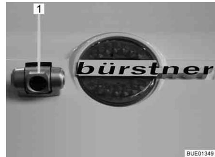
Fig. 10 Cámara de marcha atrás con iluminación infrarroja (Waeco)
