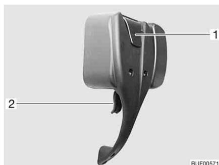
Fig. 26 Cerradura de la puerta de entrada, en el interior, bloqueada
