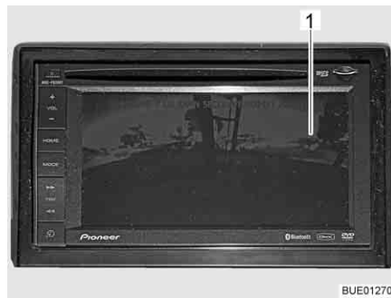
Fig. 11 Display LCD per telecamera retromarcia (Pioneer)
