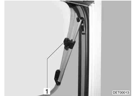
Fig. 48 Finestra apribile con deflettori a rotazione, aperta
