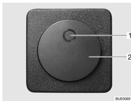
Fig. 109 Interruttore per riscaldamento elettrico del pavimento
