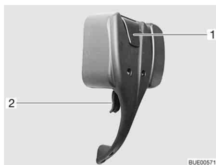
Fig. 26 Serratura della porta di ingresso, lato interno, bloccata
