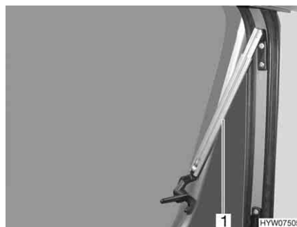
Fig. 51 Finestra apribile con deflettori automatici, aperta
