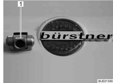
Fig. 10 Telecamera retromarcia con luce a infrarossi (Waeco)
