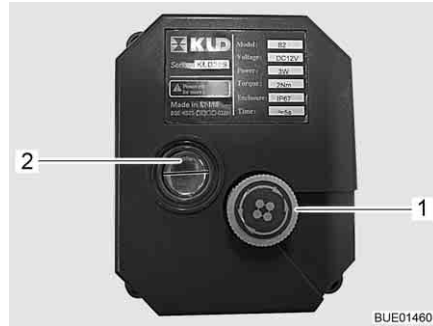
Fig. 236 Válvula de descarga de acionamento elétrico
