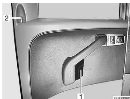
Fig. 55 Fechadura da porta do condutor, lado de dentro
