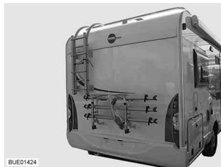
Fig. 2 Suporte de bicicletas para, no máximo, 3 bicicletas
