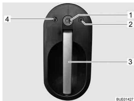
Fig. 54 Fechadura da porta do condutor, lado de fora
