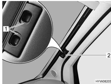
Fig. 38 Estore opaco plissado para o para-brisas
