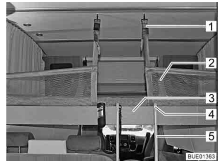
Fig. 125 Cama suspensa com rede de segurança instalada
