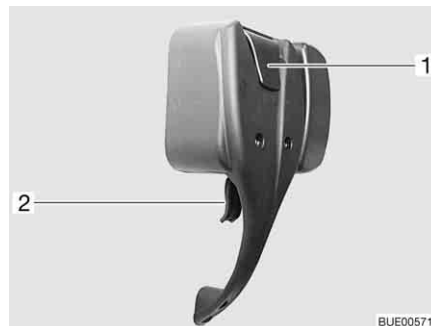
Fig. 57 Fechadura da porta de entrada, lado de dentro, trancada
