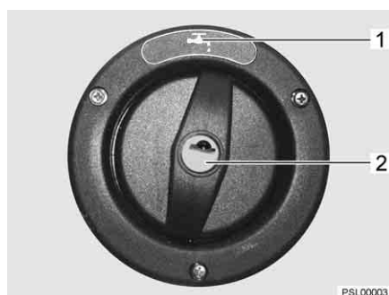
Fig. 66 Tampa de fecho do bocal de enchimento de água potável
