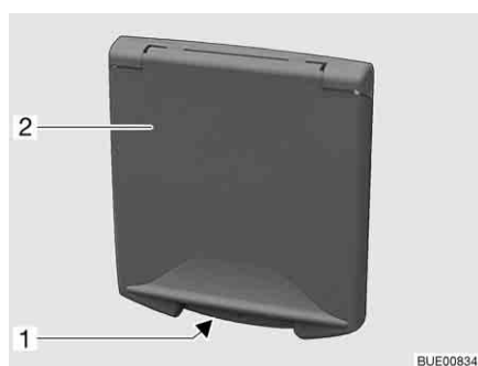
Fig. 65 Alçapão para ligação de 230 V
