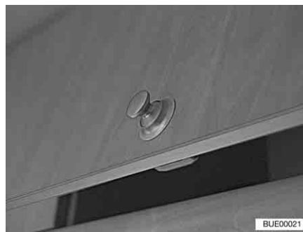
Fig. 67 Alçapão de móvel com botão de pressão
