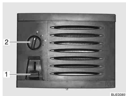
Fig. 198 Elementos de comando do permutador de calor suplementar
