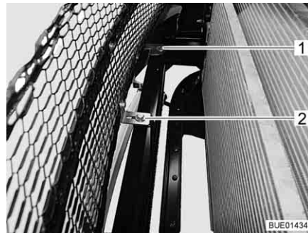
Fig. 290 Fixação da estrutura avançada de plástico
