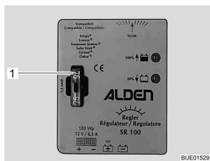
Fig. 174 Fusível do regulador de carga do painel solar 100 W
