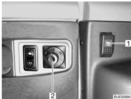
Fig. 31 Interruptor para regulação do espelho retrovisor externo e para o aquecimento do espelho retrovisor externo
