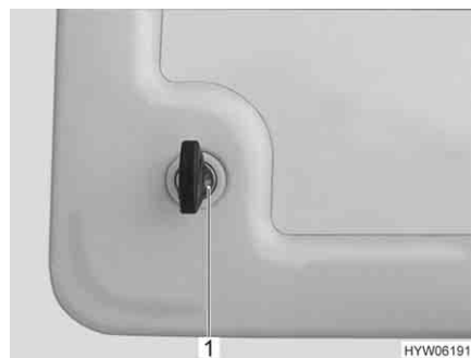
Fig. 64 Fechadura de pressão do alçapão de serviço
