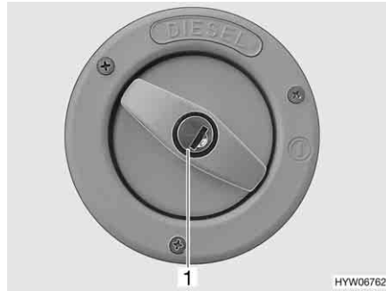
Fig. 44 Tampa de fecho do bocal de enchimento de combustível
