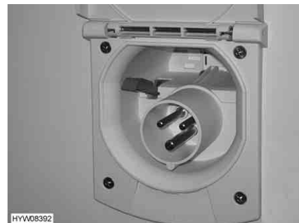
Fig. 166 Collegamento a 230 V sul veicolo
