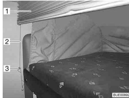
Fig. 123 Tendina oscurante pieghevole, letto basculante
