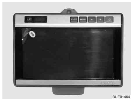
Fig. 18 Display LCD per telecamera retromarcia (Waeco)
