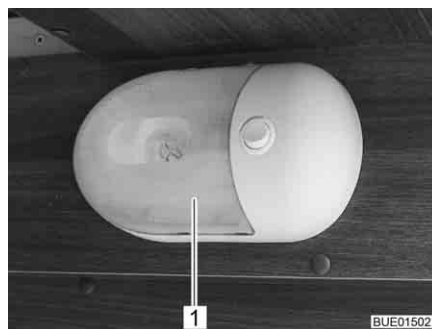
Fig. 304 Lampada del garage
