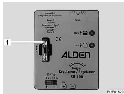
Fig. 174 Fusibile regolatore di carica del pannello solare 100 W
