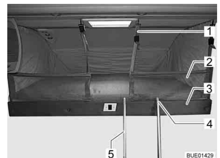
Fig. 122 Letto basculante con rete protettiva montata
