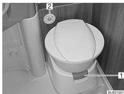
Fig. 277 Tazza del WC con centralina di controllo e di comando
