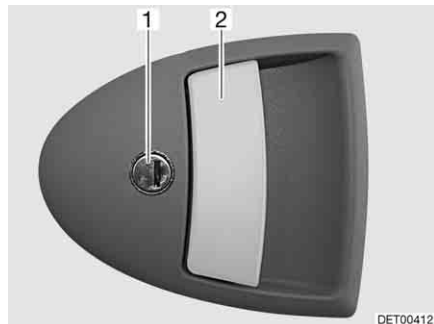
Fig. 58 Serratura della porta di ingresso, lato esterno
