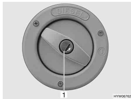
Fig. 44 Coperchio per bocchettone di riempimento per il rifornimento di carburante
