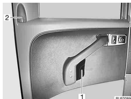
Fig. 55 Serratura della porta conducente, lato interno
