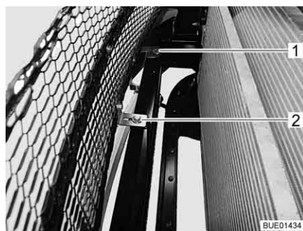
Fig. 290 Fissaggio della parte anteriore in plastica
