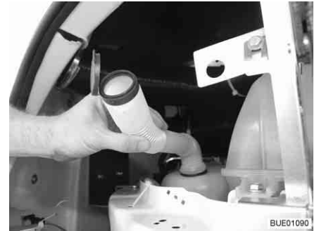
Fig. 43 Bocchettone di riempimento in posizione di riempimento
