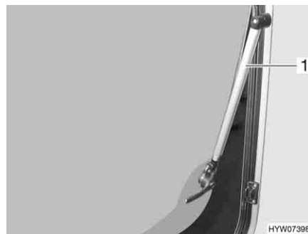
Fig. 95 Finestra apribile con deflettore automatico
