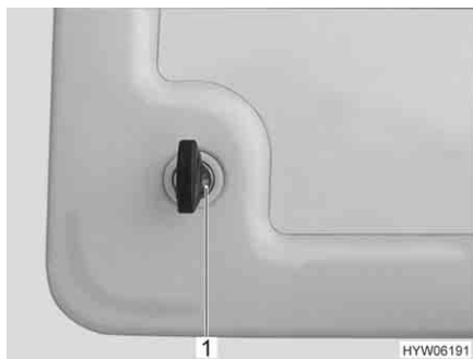
Fig. 64 Serratura a pressione sportello di servizio
