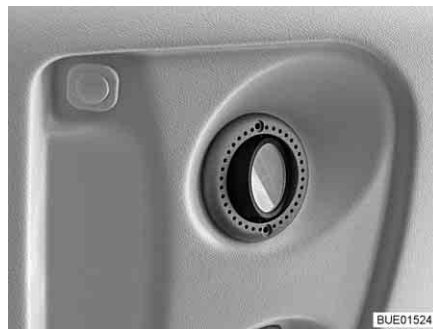
Fig. 76 Lampada alogena a incasso (esempio)
