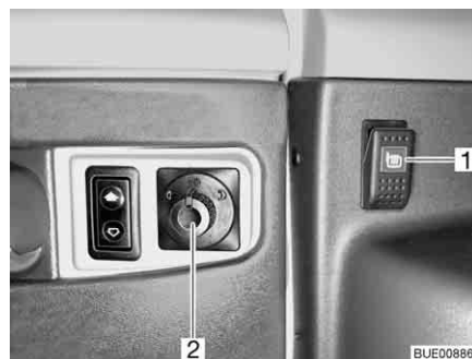
Fig. 31 Interruttore regolazione degli specchietti esterni e riscaldamento degli specchietti esterni
