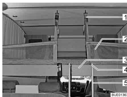
Fig. 125 Letto basculante con rete protettiva montata
