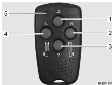
Fig. 47 Telecomando per piedini di stazionamento elettrici
