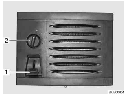
Fig. 198 Elementi di comando dello scambiatore di calore aggiuntivo
