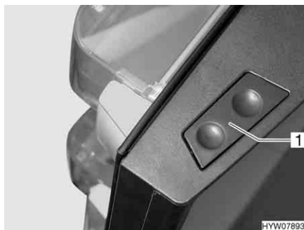
Fig. 225 Tasto di sblocco della porta del frigorifero (serie Dometic 8)
