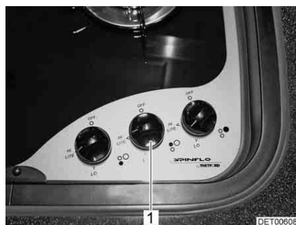
Fig. 212 Elementi di comando del fornello a gas
