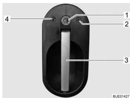
Kuva 54 Kuljettajan oven lukko, ulkoa
