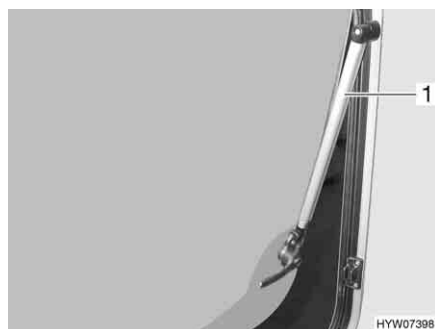
Kuva 95 Avattavat ikkunat, joissa on automaattipidikkeet
