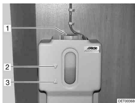
Billede 289 Udligningsbeholder varmtvandsvarmeovn
