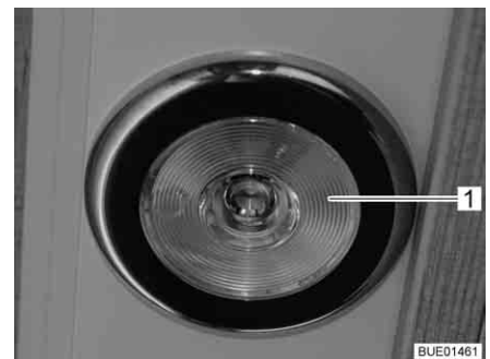
Bild 60 Infälld lampa, ljusbrytare i lampan
