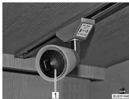
Kuva 300 Imukuppi lampun vaihtoa varten
