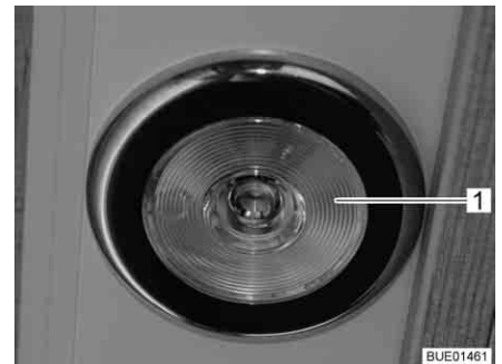
Kuva 60 Uppovalaisin, valokatkaisija valaisimessa
