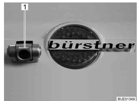
Bild 20 Backningskamera med infraröd belysning
