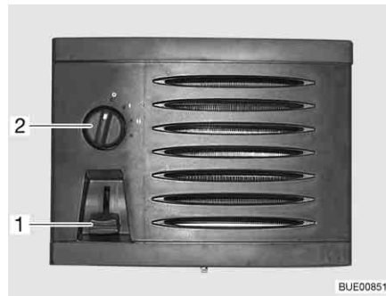
Bild 151 Reglage, knappar extra värmewäxlare
