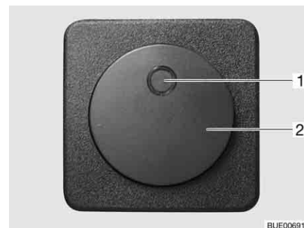
Bild 153 Brytare för elektrisk golvvärme
